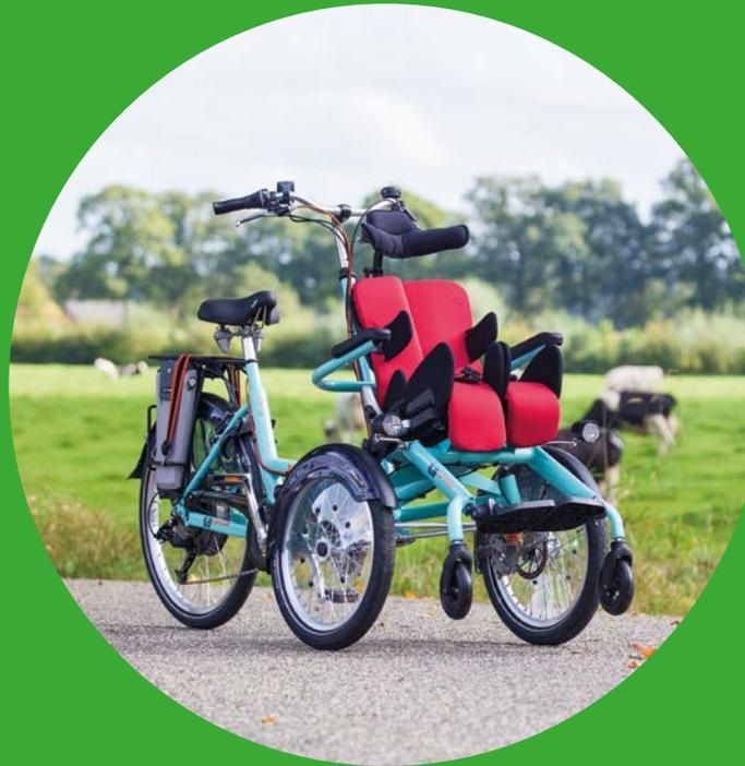
Mit einem **Rollstuhlfahrrad** ist es möglich, RollstuhlfahrerInnen schnell von Ort zu Ort zu befördern und weiter entfernte Ausflüge zu unternehmen. Das vordere Teil kann bei der teilbaren Ausführung einfach vom Fahrradteil abgekoppelt werden, sodass es vor Ort als Rollstuhl verwendet werden kann. Aber auch die Beförderung im eigenen Rollstuhl ist möglich, ganz ohne Transfer – Fahrkomfort und Stabilität.
